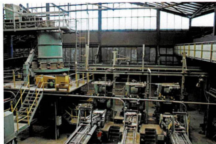
Revolverpressen und Siebrundbesicker (13, siehe Seite 3)
