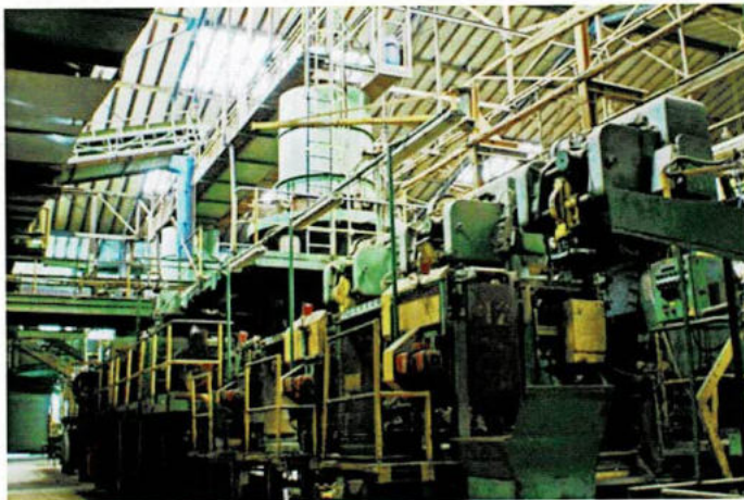
Dachziegel-Produktionsanlage, Revolverpressen (13, siehe Seite 3)
