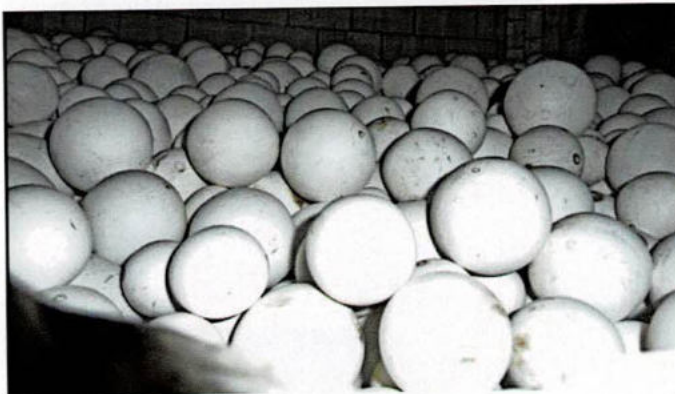
Porzellan-Mahlkugeln in Kugelmühle
