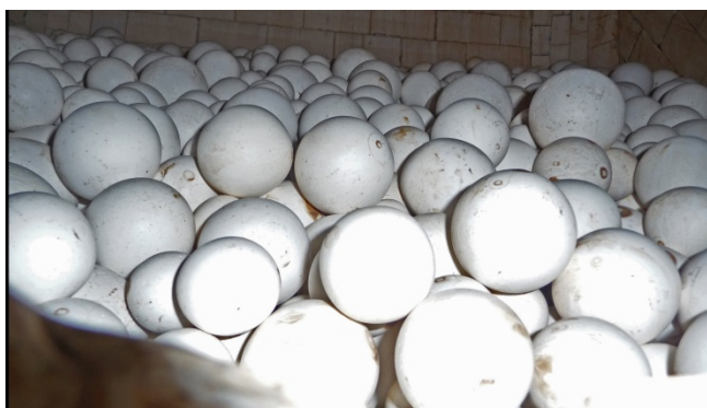
Porzellan-Mahlkugeln in Kugelmühle (29)
