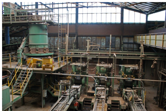
Revolverpressen und Siebrundbeschicker (13)
