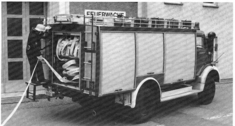
Schlauchwagen (SW 2000) 2000 m Schlauch, 1200 m gekuppelt, 800 m gerollt
