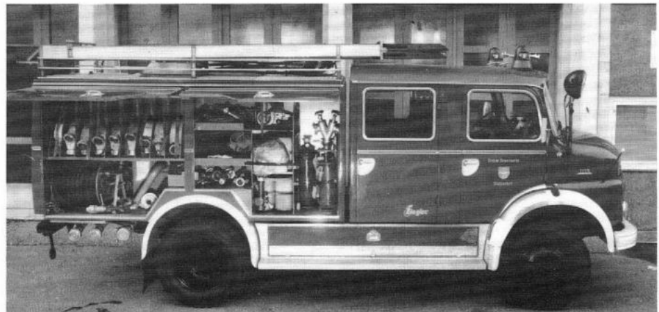
Tanklöschfahrzeug TLF 16. Fahrgestell und Motor: Daimler-Benz. Aufbau: Ziegler. Motor: 6 Zylinder Turbolader-Diesel 168 PS, Baujahr 1971. Preis: DM 107300,-.
