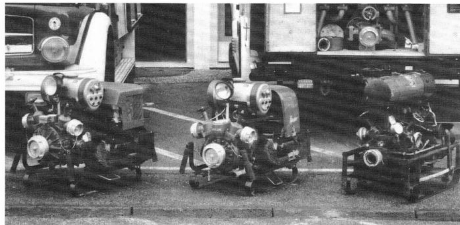
Tragkraftspritzen: links Ts 16 (1600 l/min), Mitte Ts 8 (800 l/min). Rechts eine „historische“ Magirus-Kleinmotorspritze.
