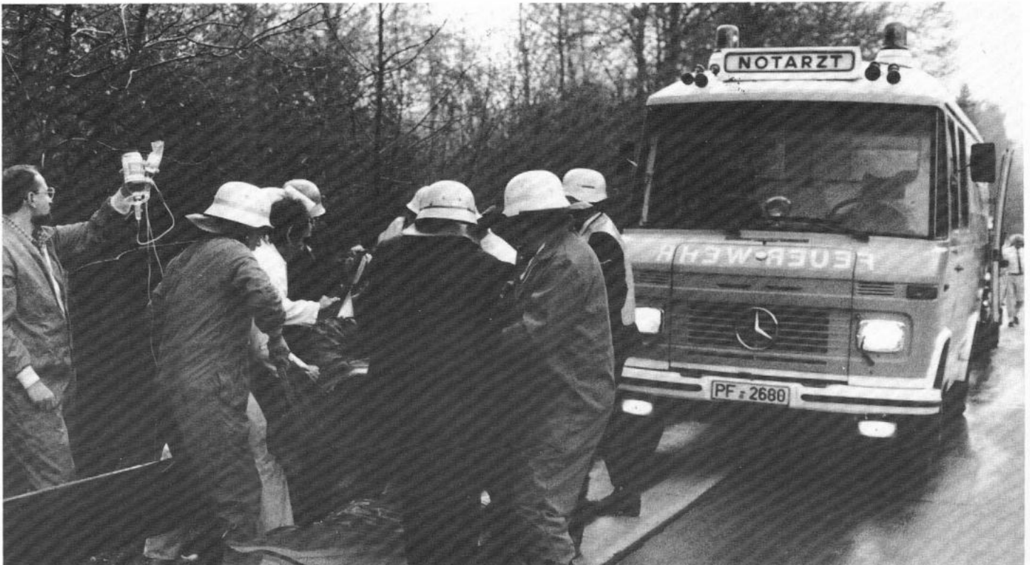
NAW Inbetriebnahme 4.2.1986. DB 613 Automatik. Fahrgestell: Daimler-Benz. Motor: 4 Zylinder Diesel, 130 PS. Baujahr: 1986. Aufbau: Binz.
