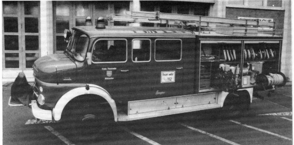
Löschfahrzeug LF 16-Ts. Fahrgestell und Motor: Daimler-Benz. Aufbau: Ziegler. Motor: 6 Zylinder Diesel mit Turbolader 168 PS. Baujahr 1975. Preis: DM 161984,-.
